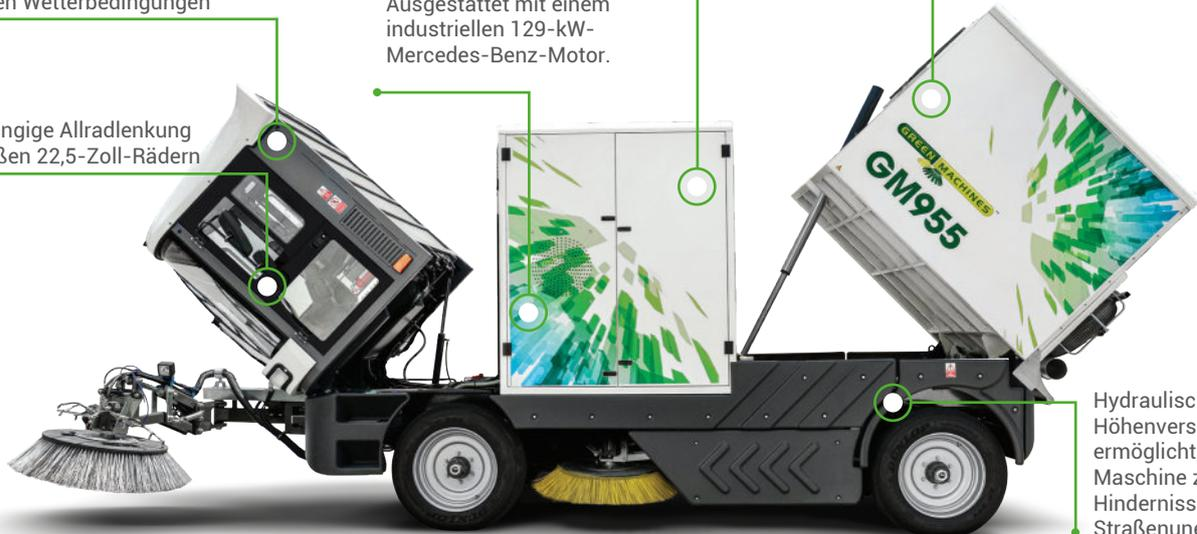
Die kippbare Kabine ist an Stoßdämpfern aufgehängt, die einen schnellen Zugang zum Motor und den Hydrauliksystemen ermöglichen, sodass die Wartung einfach und hocheffizient durchgeführt werden kann, wodurch Zeit und Geld gespart werden
