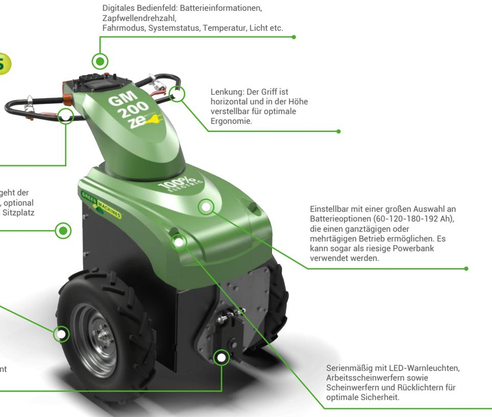
Digitales Bedienfeld: Batterieinformationen, Zapfwelldrehzahl, Fahrmodus, Systemstatus, Temperatur, Licht etc.
